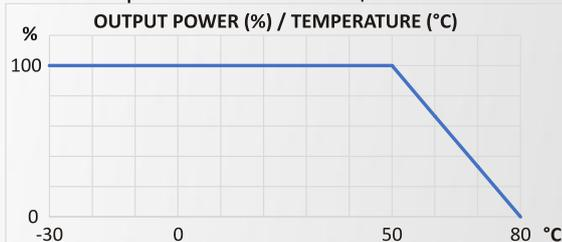
Таким образом, если зарядное устройство вынуждено работать при температуре выше  $+50^{\circ}\text{C}$ , оно просто снизит выходную мощность до соответствующего значения в приведенной выше таблице и продолжит нормальную работу.
